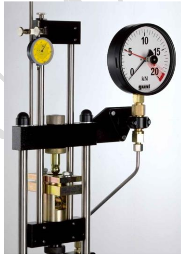
Şekil 2. GUNT WP 300.11 Erichsen deney düzeneđi [2].
